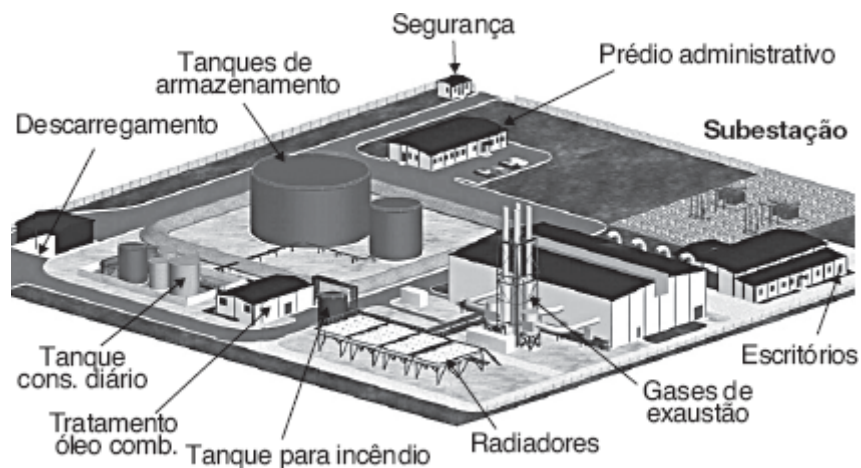
Figura 16.25(a) Vista tridimensional da usina termelétrica a óleo combustível de 170 MW — Wärsilä.
