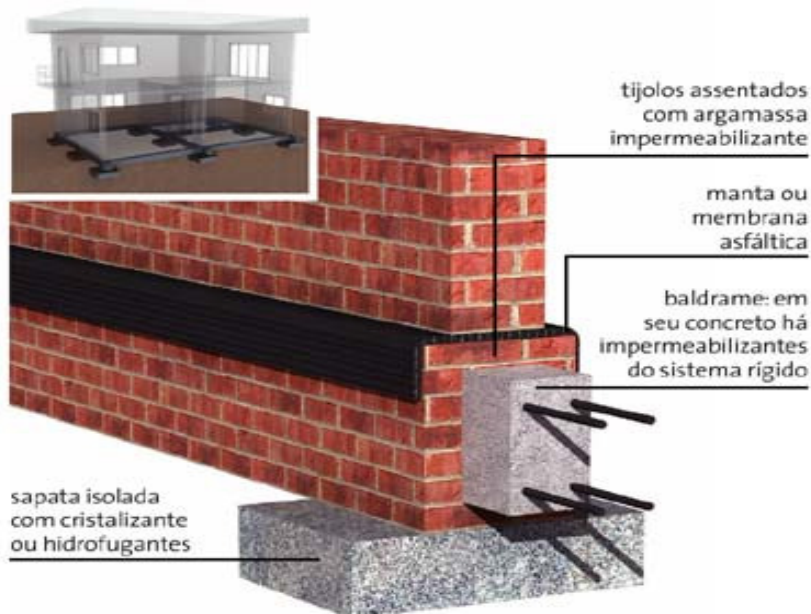
Figura 6 – Corte esquemático do alicerce
