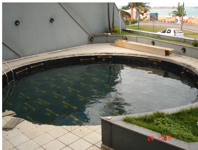
Figura 14 – Teste de estanqueidade
