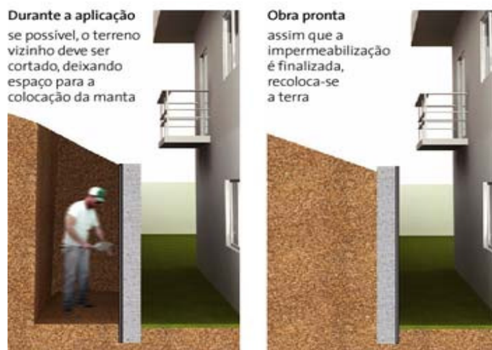
Figura 3 – Impermeabilização de parede de encosta
