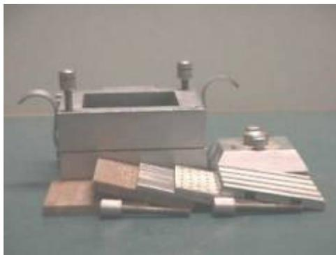
O ensaio consiste na aplicação de um deslocamento à semi-caixa inferior, produzido por um motor cuja velocidade é regulável por um sistema de transmissão de carretos, transformando o movimento de rotação num movimento rectilíneo uniforme. Este movimento gera tensões tangenciais, que vão aumentando gradualmente à medida que se processa o deslocamento, até se dar a rotura segundo um plano horizontal de corte.
