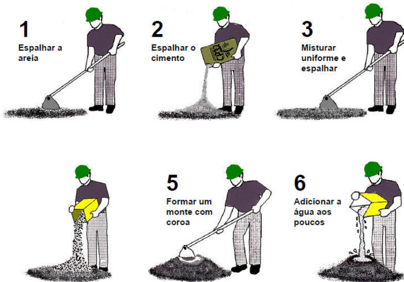
Figura 45. Execução manual do concreto.
