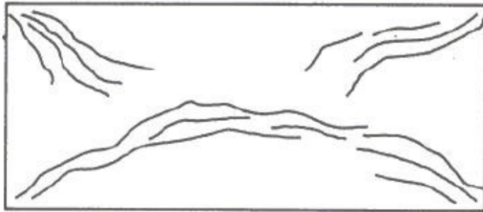
Insuficiência de armadura positiva
