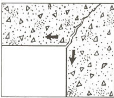
Figura 58. Fissuras em cantos.
