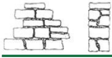
Pedras com aparelho parcial, dispostas em camadas.
