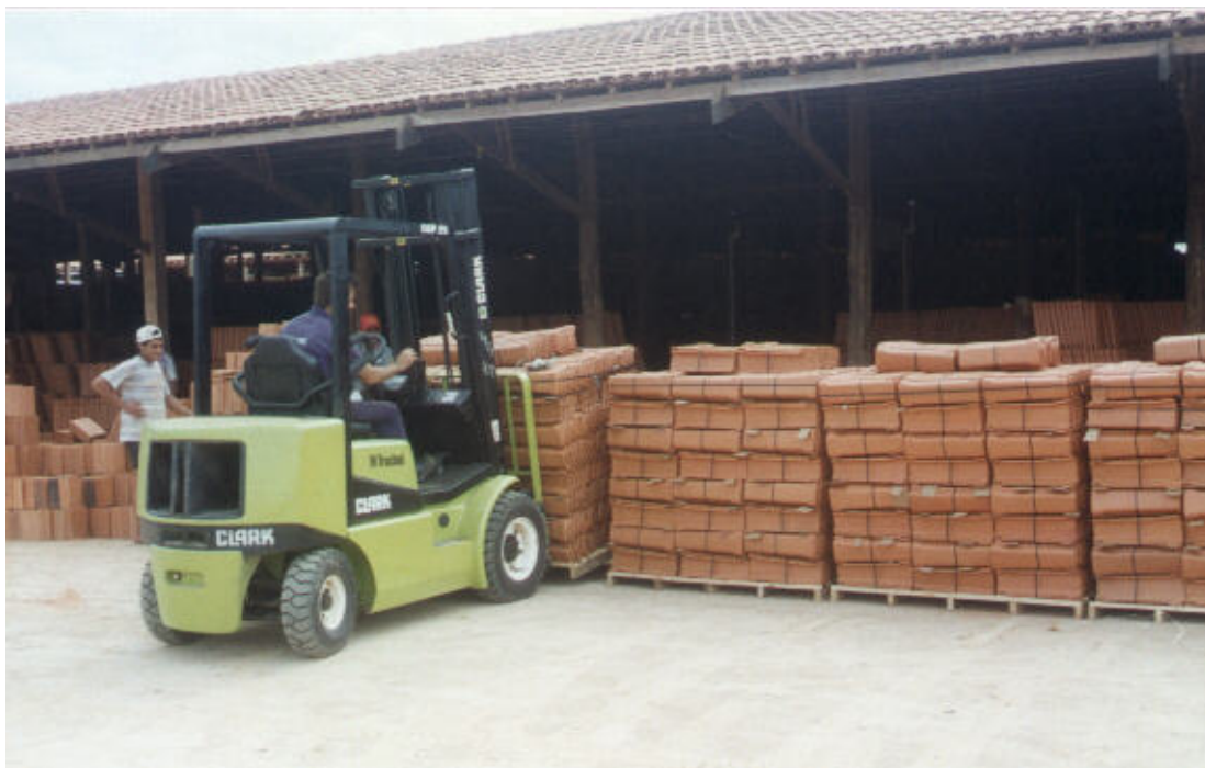
Figura 33. Carregamento paletizado de telhas cerâmicas.
