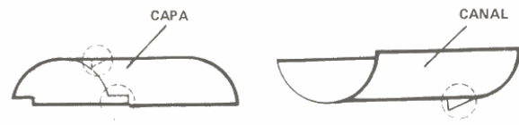
Figura 21. Capa e canal da telha paulista.
