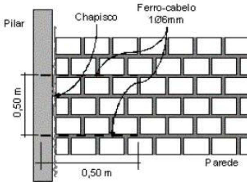
Figura 33. Ligação da parede com pilar.
