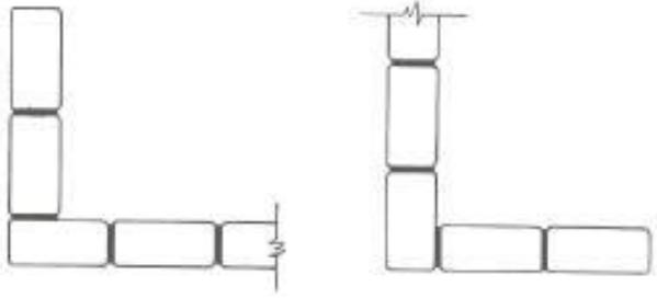
Figura 23. Alvenaria de 1/2 tijolo.
