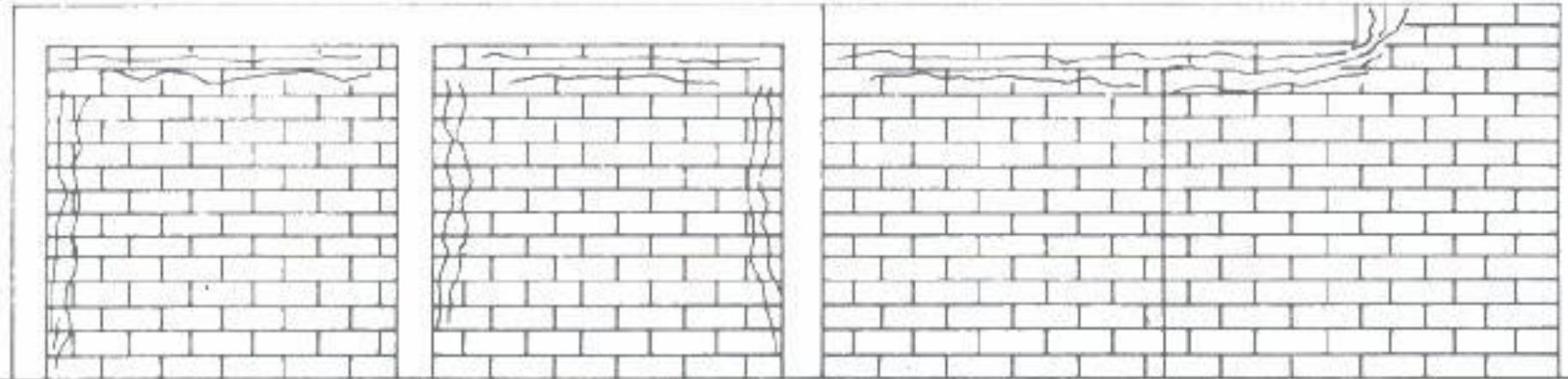
**Figura 41. Fissuras térmicas.**
