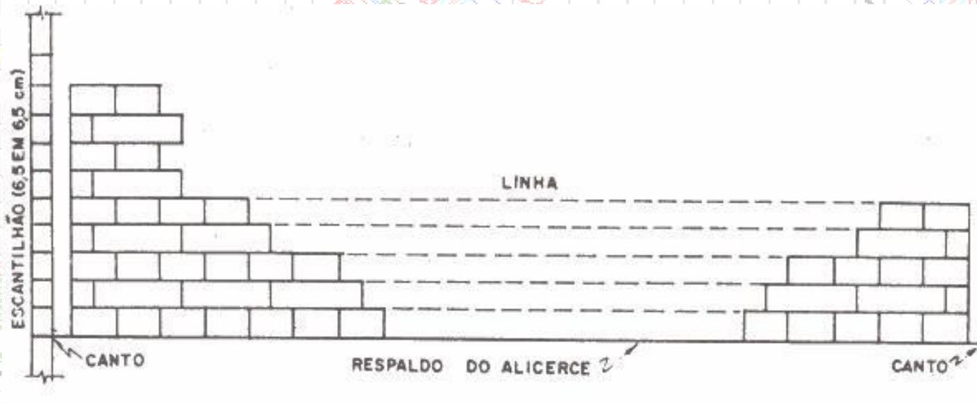
Figura 15. Execução de parede de alvenaria.
