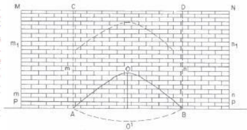
Figura 40. Fissuras em forma de parábola alongada.
