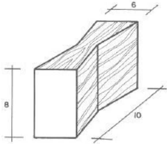
Figura 19. Dimensões do taco de madeira para batente.
