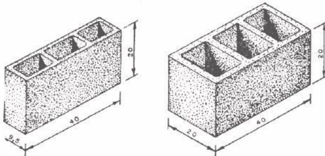
Figura 6. Bloco de concreto.
