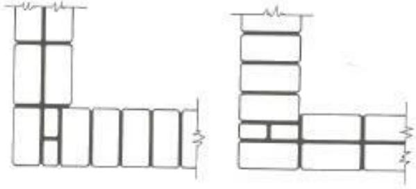
Figura 24. Alvenaria de um tijolo.
