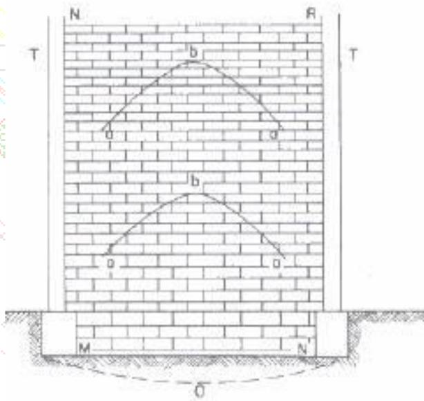
Figura 39. Fissuras parabólicas.
