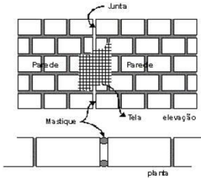
**Figura 34. Ligação de parede com parede, sem amarração.**
