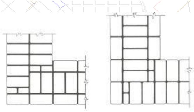
Figura 26. Alvenaria de dois tijolos.
