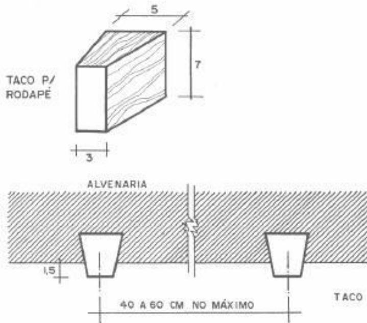
Figura 21. Tacos para fixação de batentes de portas.
