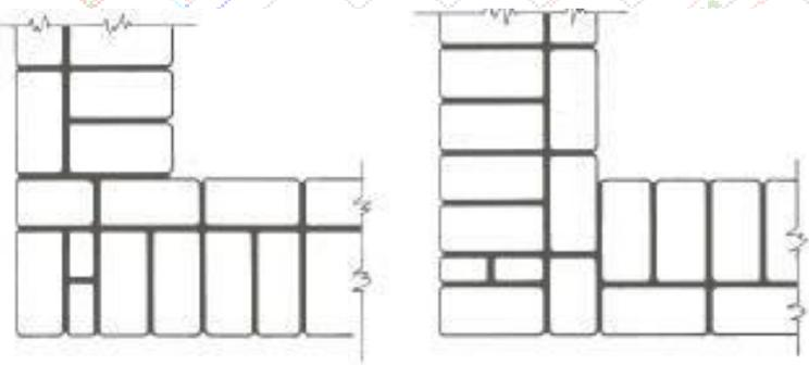
Figura 25. Alvenaria de um tijolo e meio.
