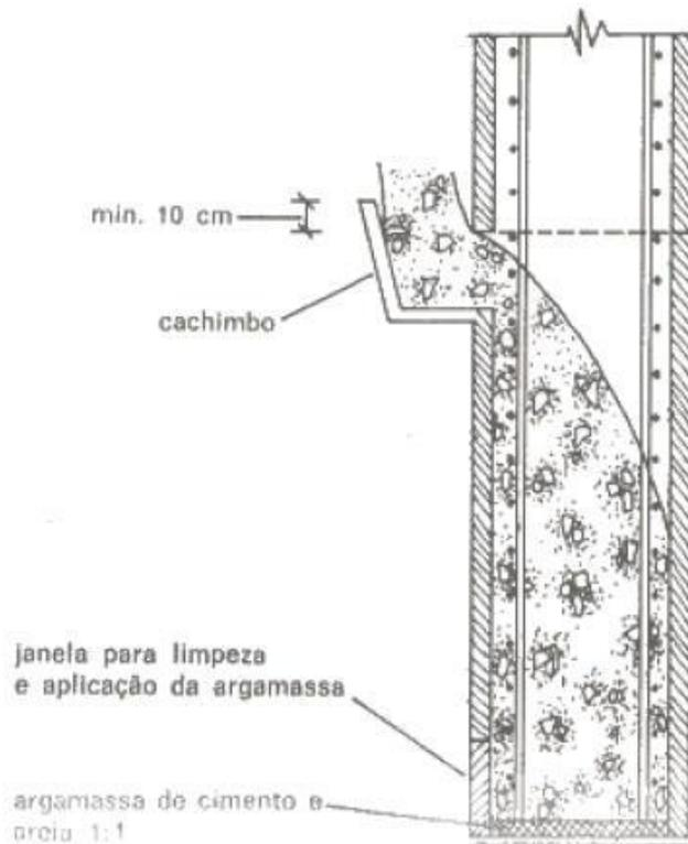
Figura 49. Lançamento do concreto por calha.
