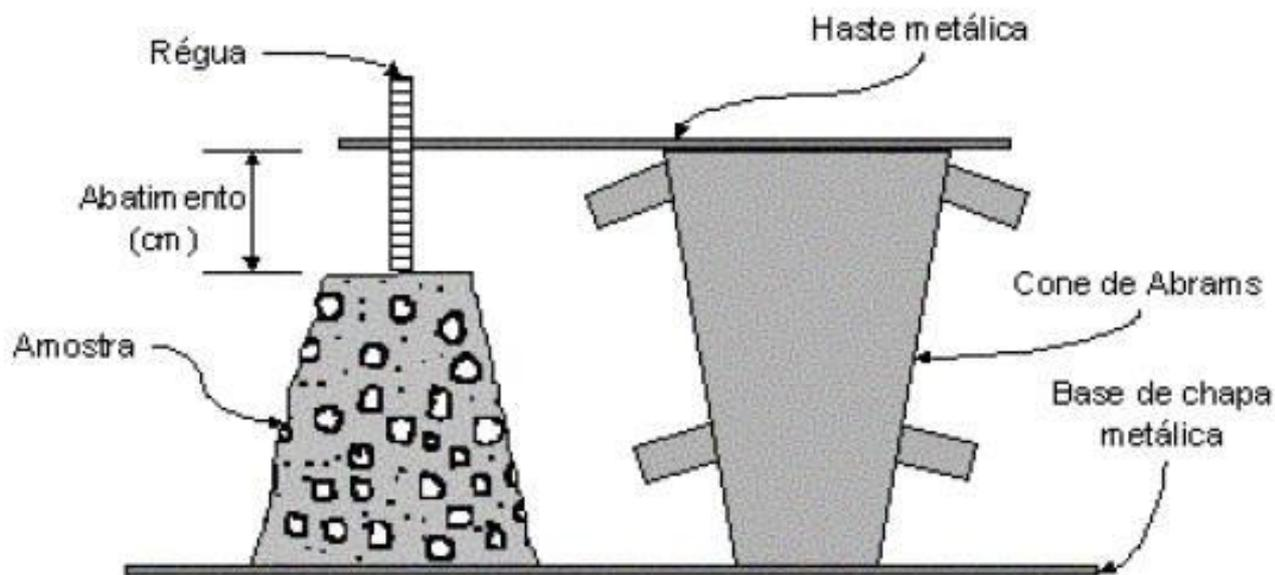
Figura 47. *Slump test*.
