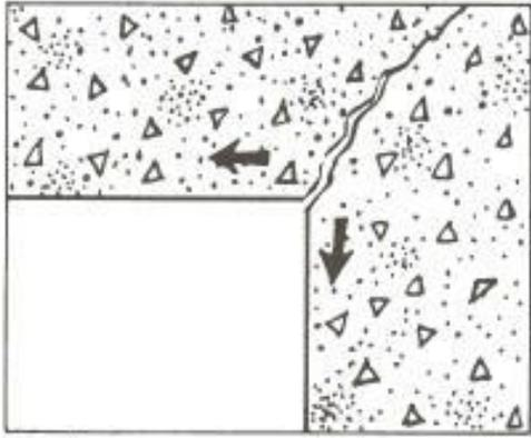
Figura 58. Fissuras em cantos.
