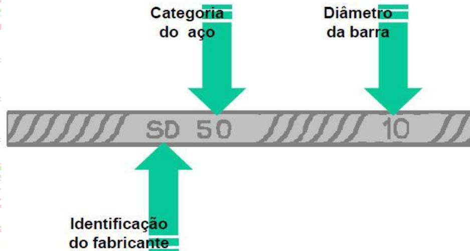
Figura 29. Marcas de laminação em relevo em barras de aço.
