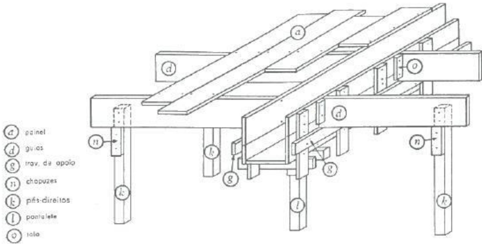
**Figura 12. Fôrma da viga com a laje.**
