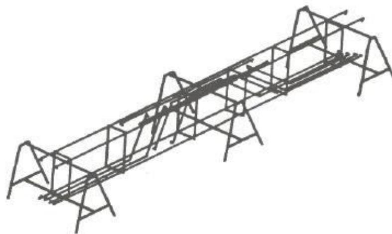
Figura 44. Montagem de armaduras sobre cavaletes
