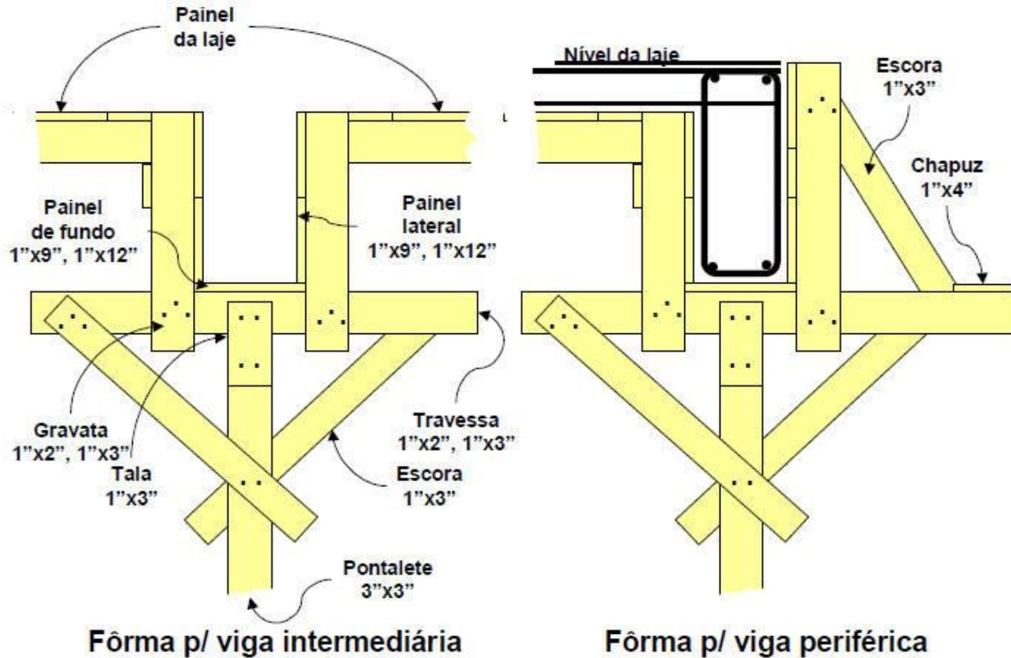
Figura 17. Execução da fôrma da viga.
