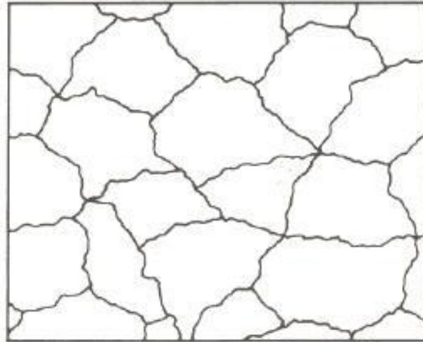
**Figura 57. Fissuras por acabamento.**
