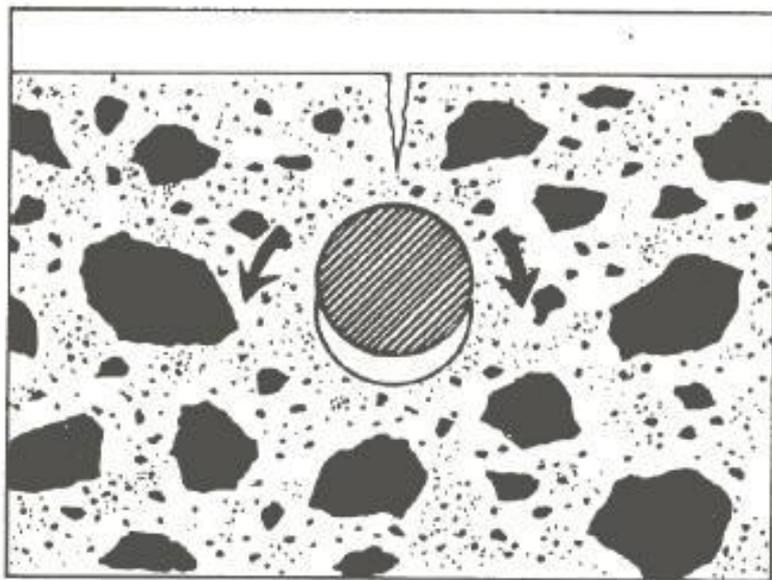
Figura 51. Sedimentação do concreto impedida pela armadura.
