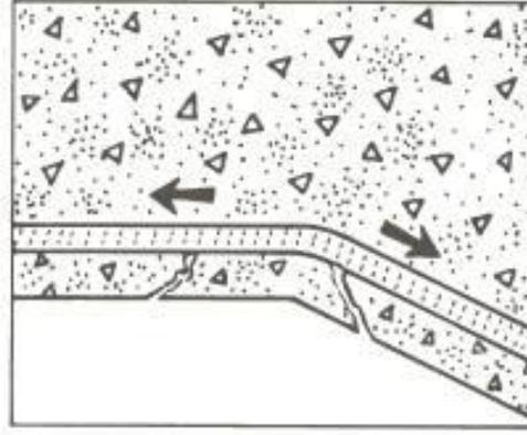
Figura 59. Mudança de direção da armadura.
