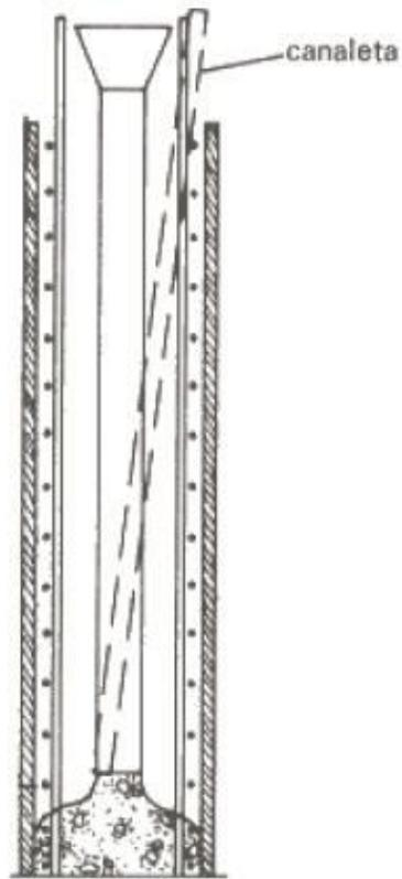
Figura 48. Lançamento do concreto por tromba ou canaleta.
