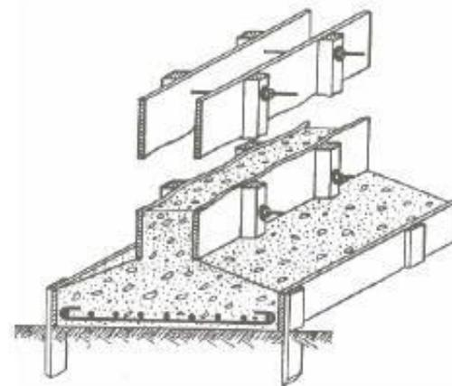
Figura 24. Fôrma de sapata corrida.
