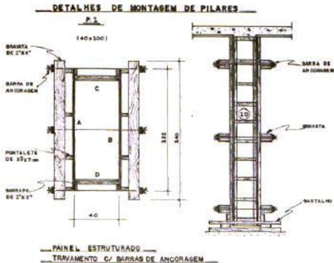
**Figura 8. Reforço das travessas por meio de barras de ancoragem.**
