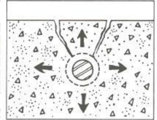
Figura 60. Oxidação da armadura.
