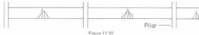
**Insuficiência de armadura positiva na viga**
