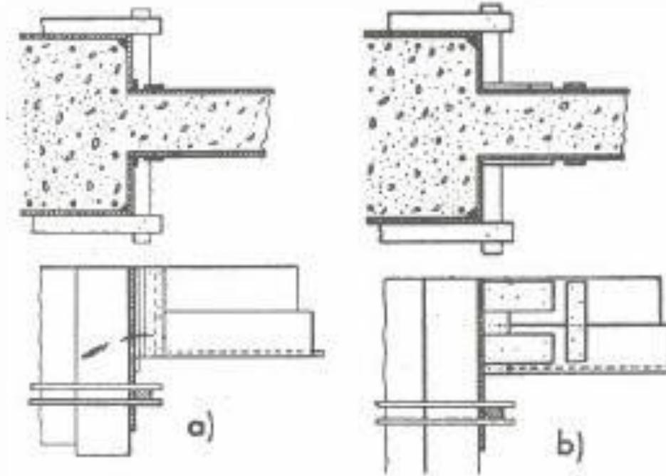
**Figura 15. Emendas da fôrma de viga com a fôrma do pilar.**
