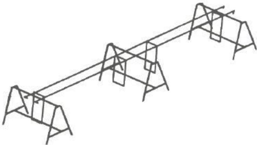
Figura 43. Montagem de armaduras sobre cavaletes
