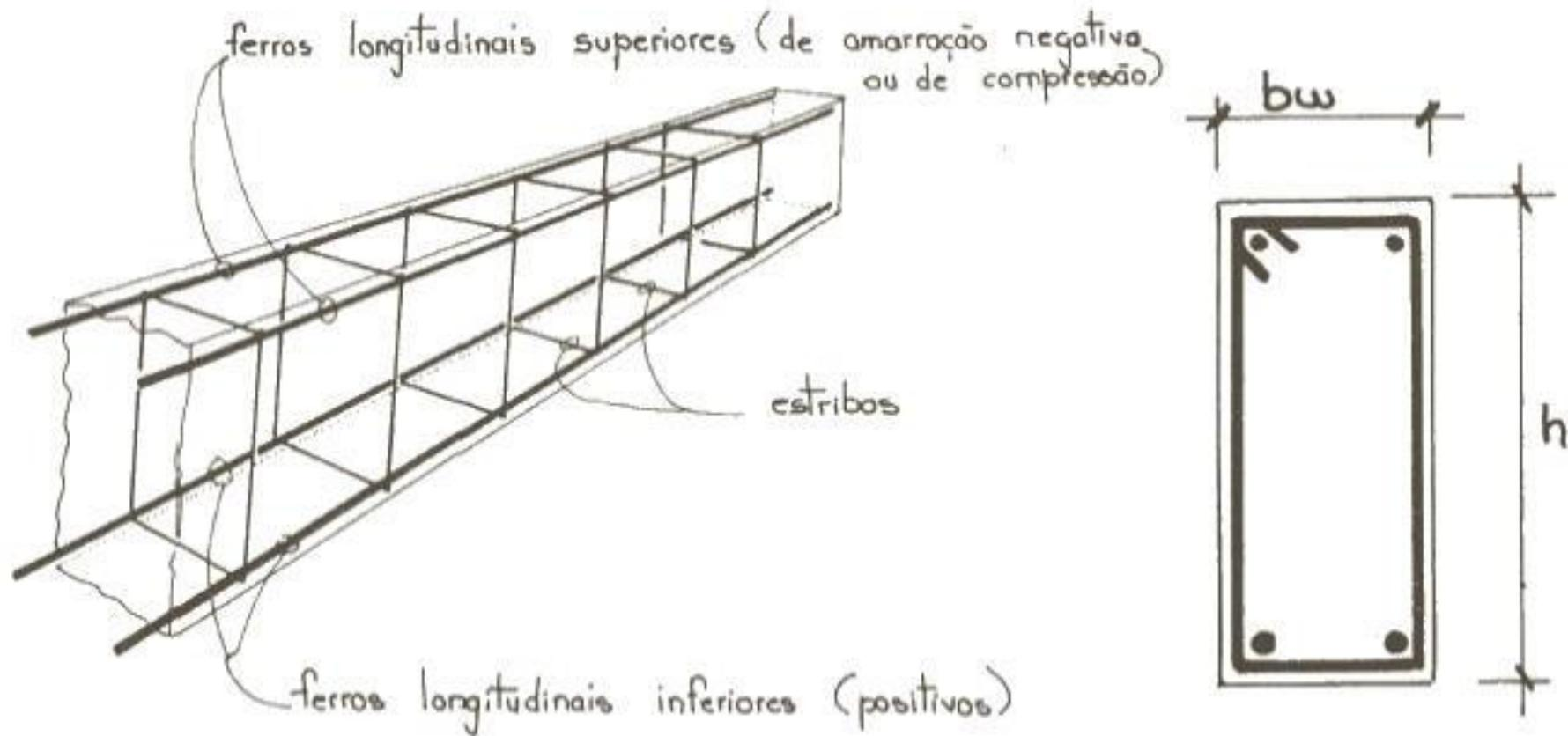
**Figura 31. Armadura de viga simples.**
