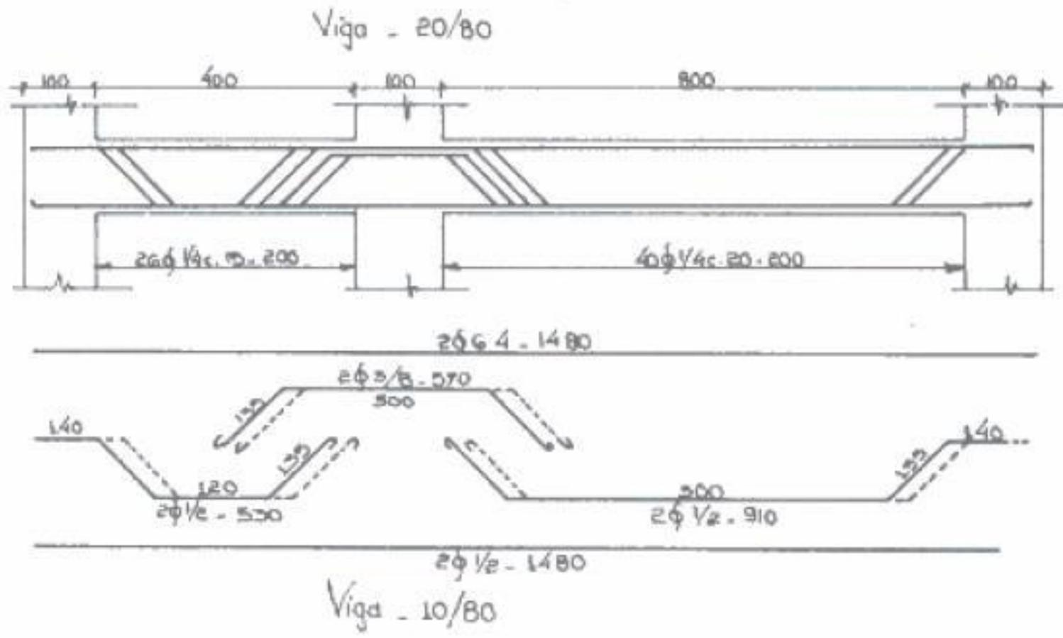
Figura 32. Viga com ferro dobrado.
