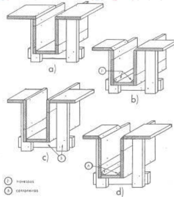
**Figura 13. Formas de ligação da viga com a laje.**
