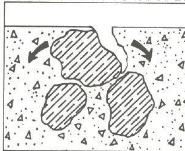
Figura 52. Sedimentação do concreto impedida pela argamassa.
