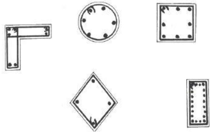
Figura 34. Armadura de outros pilares.
