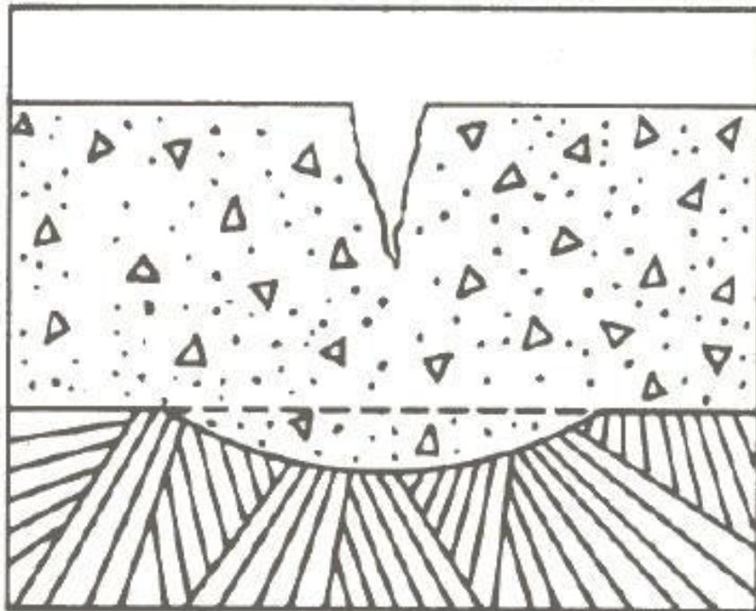
**Figura 54. Movimentação da fundação ou fôrma.**
