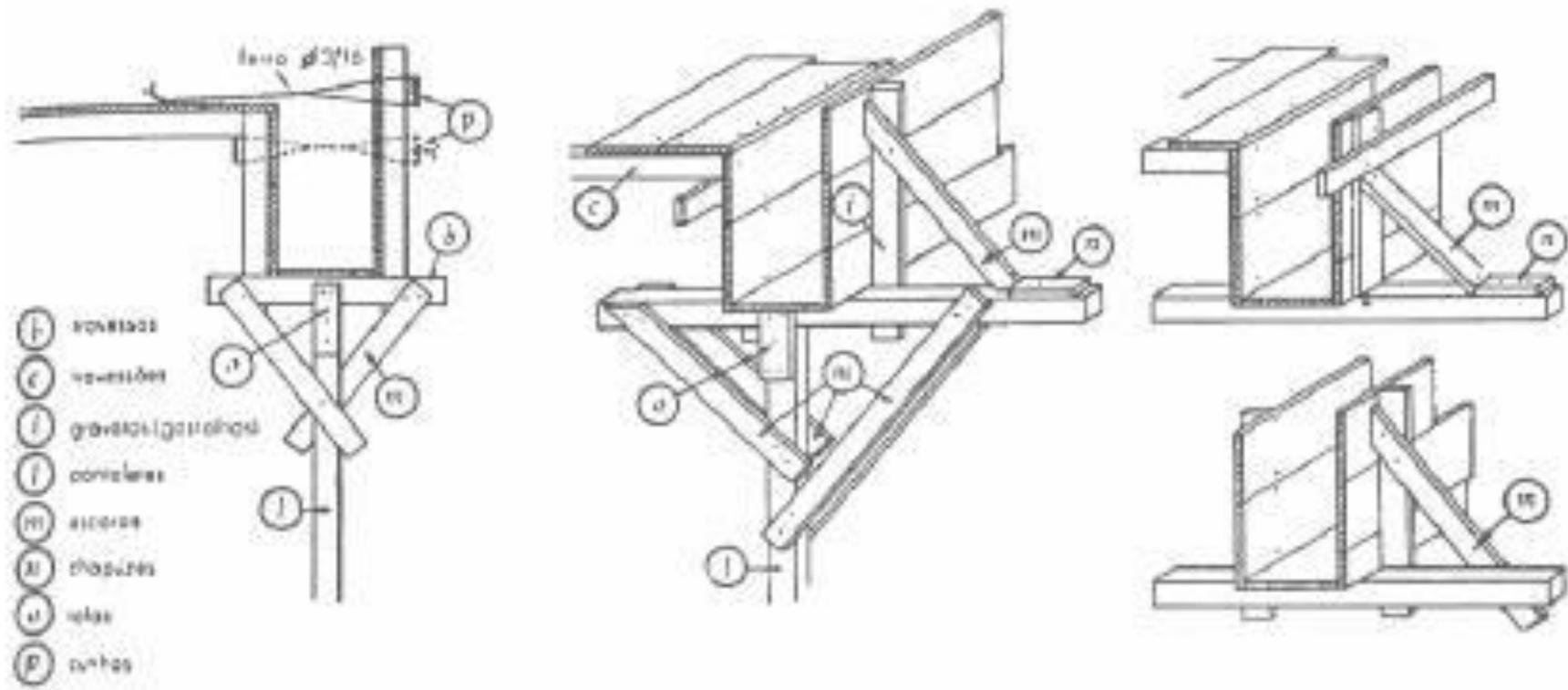
**Figura 14. Vigas de extremidade.**
