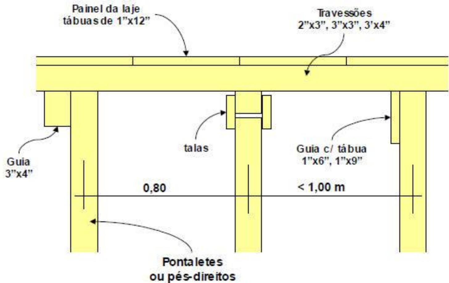
Figura 20. Execução da fôrma da laje.
