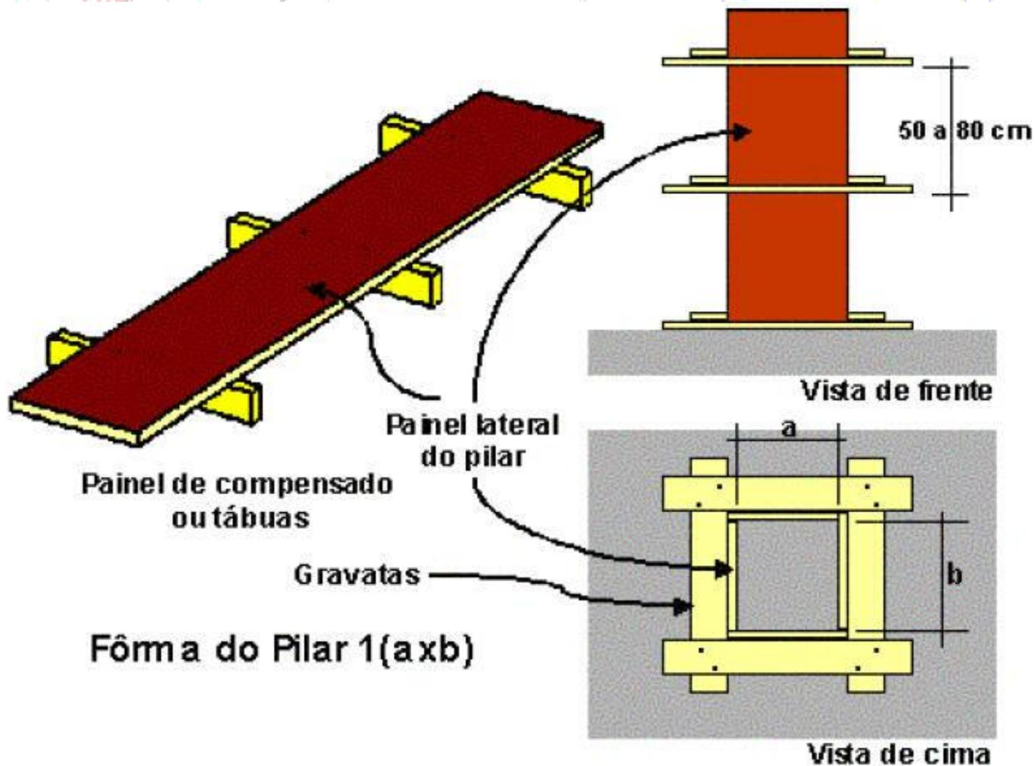
Figura 9. Execução da fôrma do pilar.
