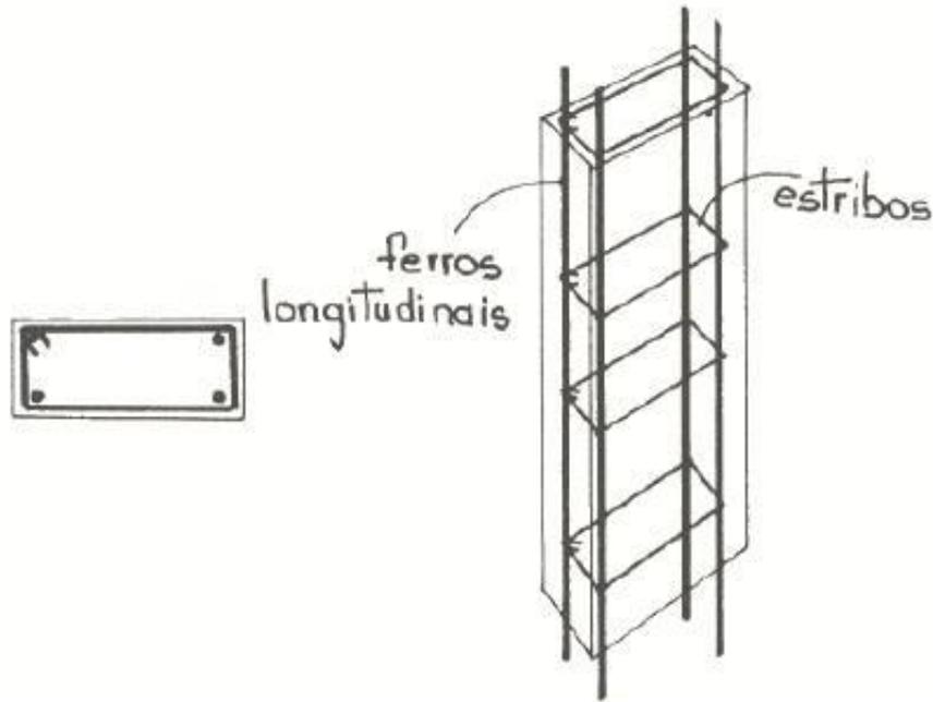
Figura 33. Armadura de pilar.
