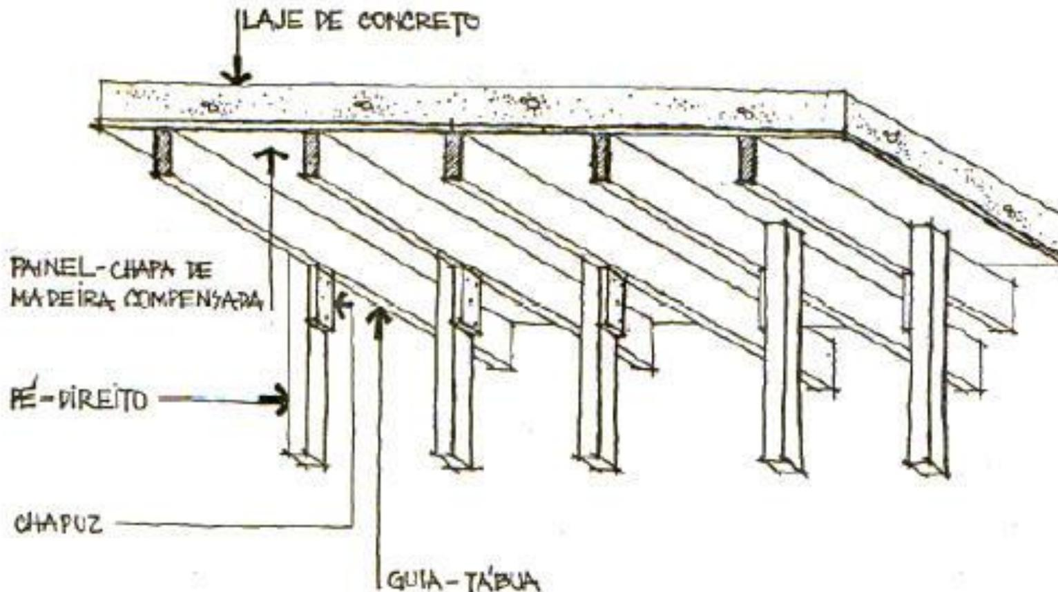
Figura 19. Fôrma de laje: tábuas apoiadas diretamente sobre as guias.
