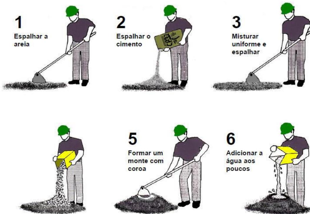
Figura 45. Execução manual do concreto.
