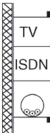
Condutores isolados ou cabos unipolares em canaleta provida de separações sobre parede
