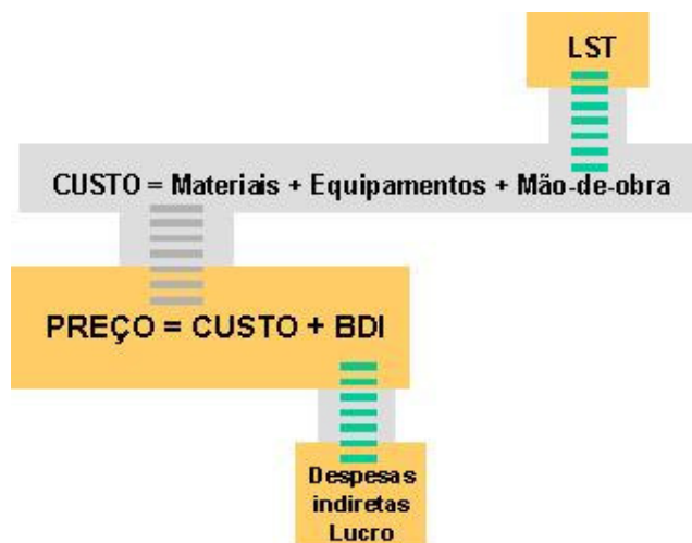
Figura 4. Método de cálculo do preço de um serviço (LST – Leis Sociais Trabalhistas; BDI – Benefícios e Despesas Indiretas).
