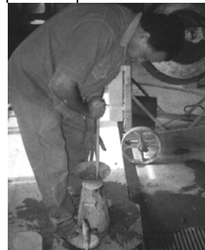
Adensamento das camadas de concreto
