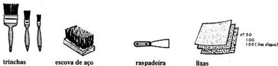
Figura 17. Materiais para aplicação de pintura em metal.
