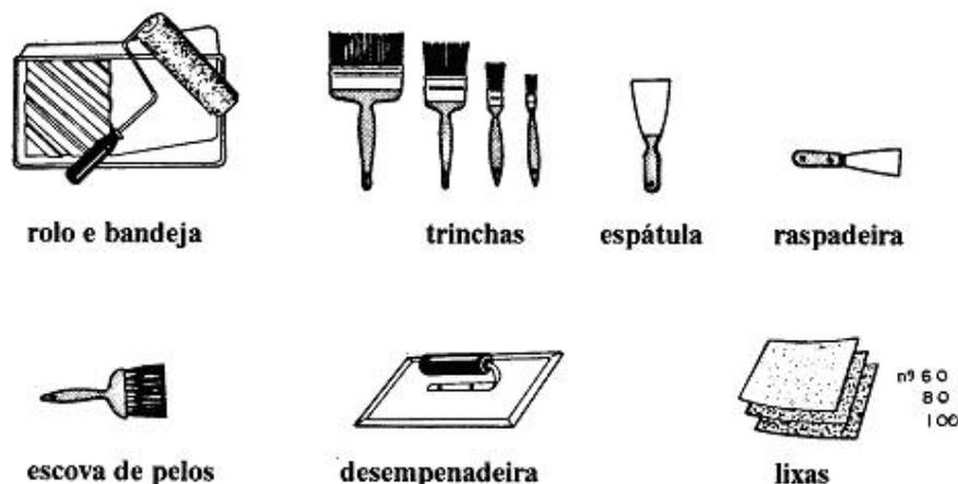
**Figura 18. Materiais para aplicação de pintura em alvenaria.**
