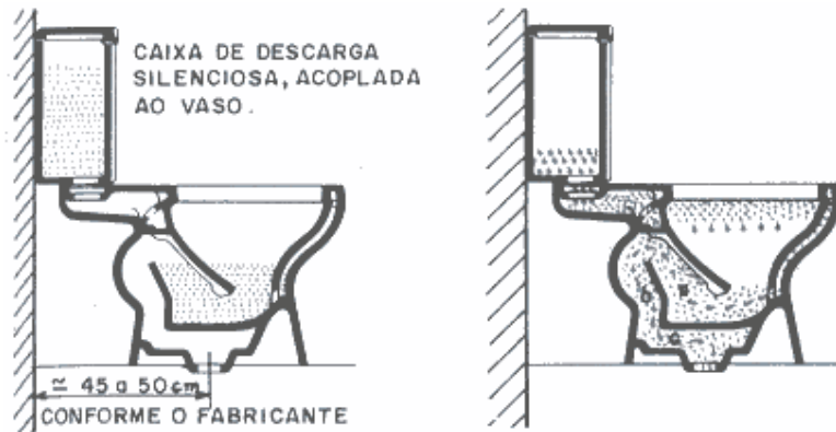
Figura 14. Vaso sanitário auto-sifonado, canal posterior.
