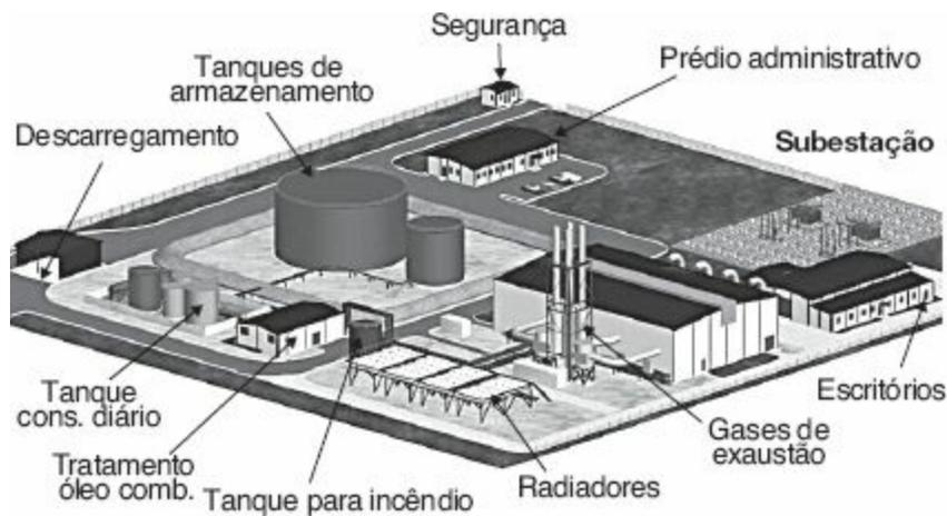
**Figura 16.25(a)** Vista tridimensional da usina termelétrica a óleo combustível de 170 MW — Wärtsilä.
