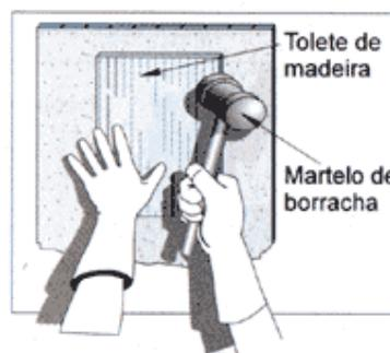
**Figura 23. Bater levemente a placa.**
