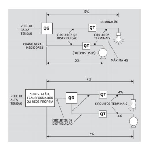
Limite de queda de Tensão Segundo a norma NBR 5410, os limites de queda de tensão em uma instalação elétrica são:
