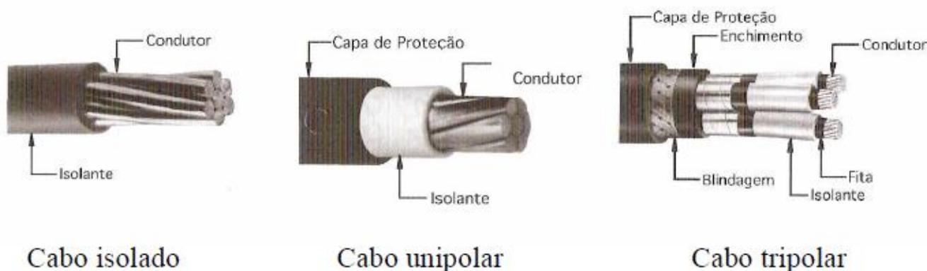
Os cabos de alta tensão têm uma constituição bem mais complexa do que os de baixa tensão, devido aos elevados gradientes de tensão de campo elétrico a que são submetidos.
