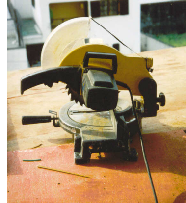
Serra para cortes e ajustes dos lambris
