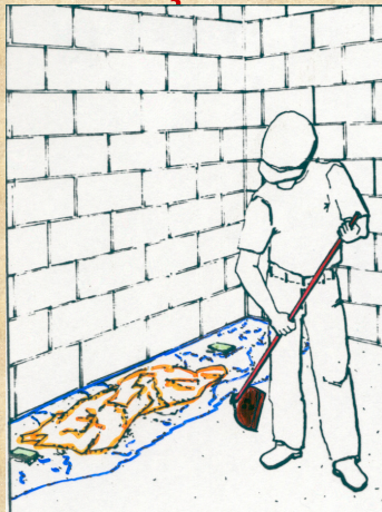
EXECUÇÃO DA MESTRA
