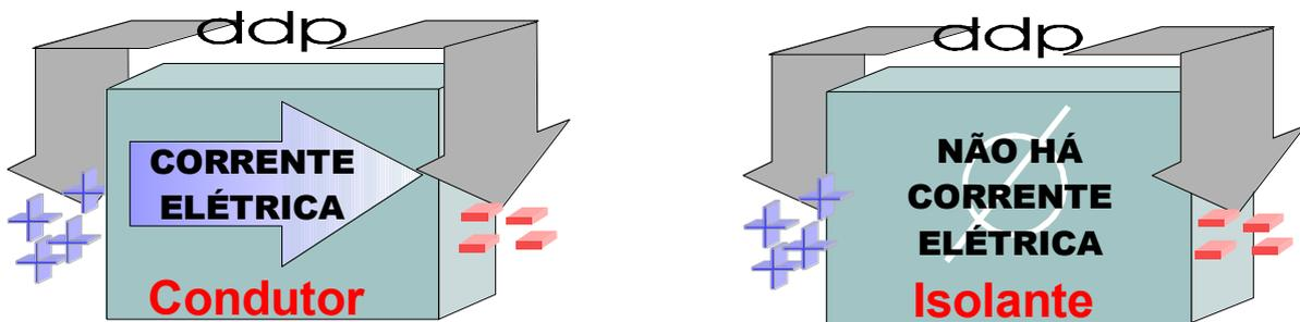
**Fig.1** Efeitos da ddp em condutores e isolantes.
