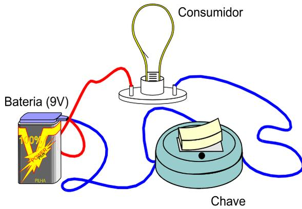
**Fig.16** Chave desligada.
