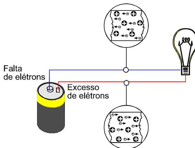
**Fig.12** Movimento de elétrons em um circuito simples.
