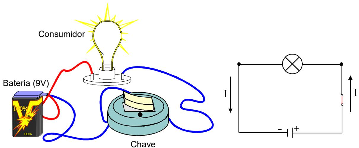
**Fig.21** Representação de uma chave na condição "ligado".
