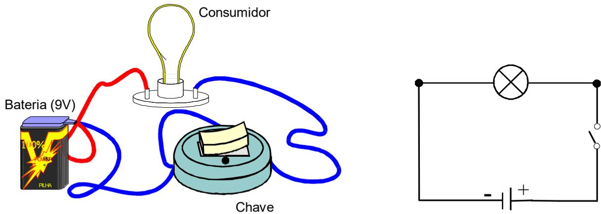
**Fig.20** Representação de uma chave na condição "desligado".
