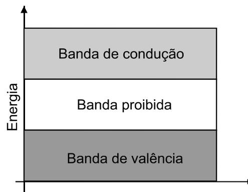
**Fig.8** Bandas de Energia e banda proibida.
