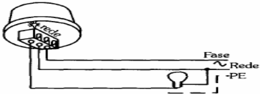
Figura 164 – Relé instalado sem interruptor.
