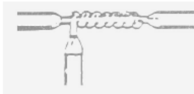
Figura 94 – Emenda em derivação.
