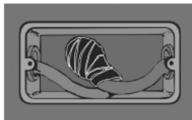
Figura 100 – Emenda soldada e isolada.
