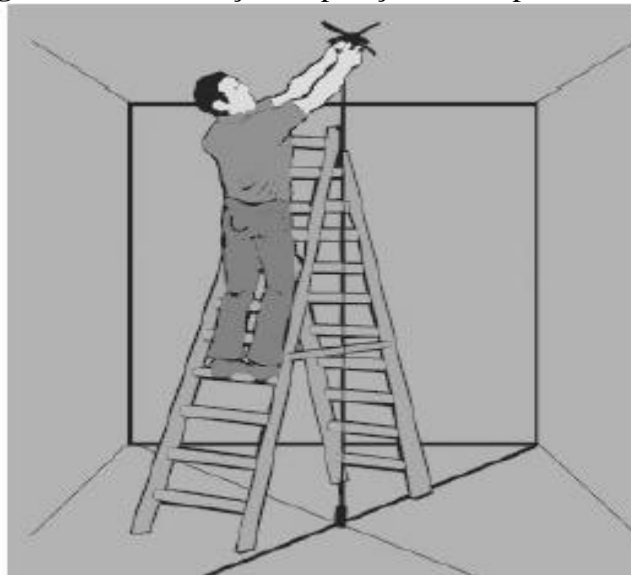
Figura 129 – Marcação da posição da lâmpada no teto.
