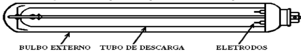
Figura 18 – Lâmpada de vapor de sódio de baixa pressão.
