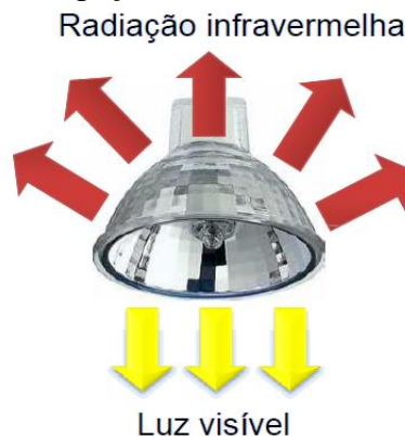
Figura 12 – Dissipação da luz visível e infravermelha.
