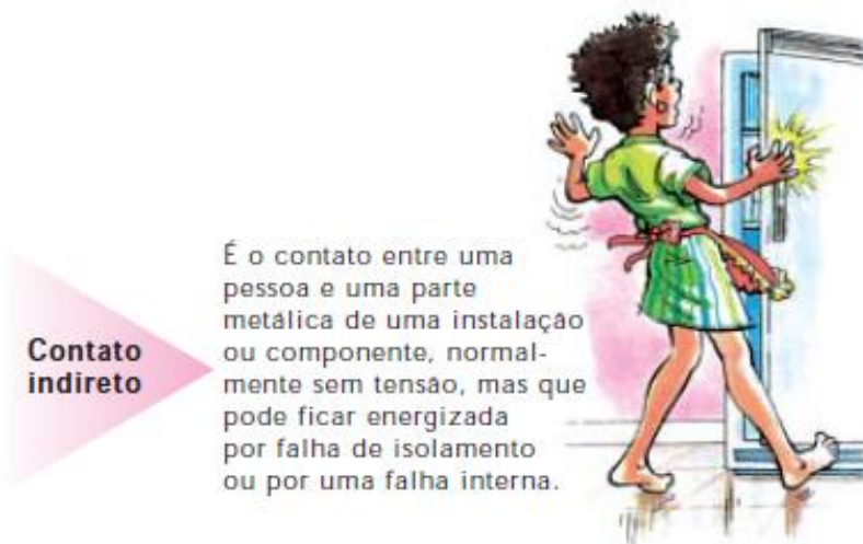
Figura 4 – Contato Indireto.
