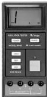
Existem megôhmetros sem esse botão, nos quais a tensão do gerador se mantém constante, independentemente da velocidade do giro da manivela.
