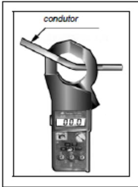
O volt-amperímetro alicate é indispensável em instalações industriais, para medições da corrente elétrica de motores, transformadores, cabos alimentadores de painéis. No entanto, com este instrumento só é possível medir corrente elétrica alternada, pois seu funcionamento se baseia no princípio da indução eletromagnética.
