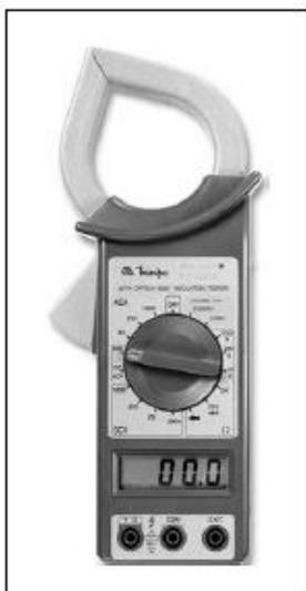
Na medição de corrente elétrica, o manuseio do volt-amperímetro alicate difere do manuseio do multímetro, pois com ele não é necessário interromper o circuito para colocá-lo em série. Basta abraçar o condutor a ser medido com a garra do alicate.
