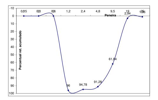
O diâmetro máximo do agregado graúdo foi definido como a malha da peneira na qual ficou retido acumulado o percentual igual o imediatamente inferior a 5% o que resultou Diâmetro máximo = 19 mm.
