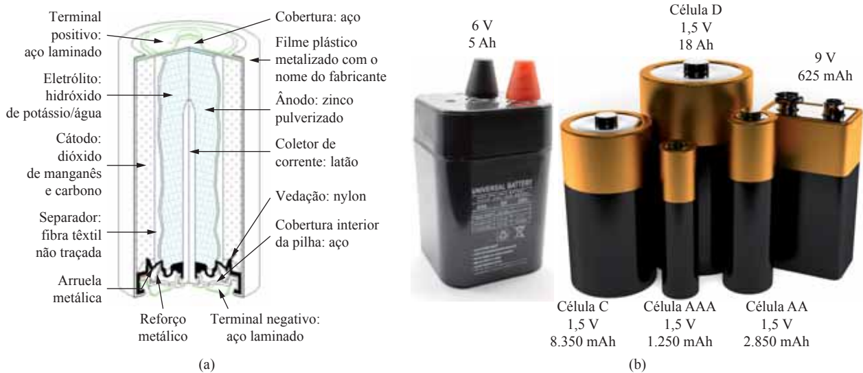
Figura 2.12 Célula alcalina primária: (a) vista em corte de uma célula alcalina cilíndrica; (b) vários tipos de células primárias. (© Cortesia de (a) Hamera/Getty Images; (b) iStockphotos/Getty Images)
