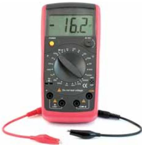
**Figura 10.24** Medidor digital da capacitância. (Cortesia de oksana2010/Shutterstock.)
