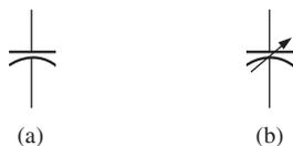
**Figura 10.11** Símbolos para o capacitor: (a) fixos; (b) variáveis.
