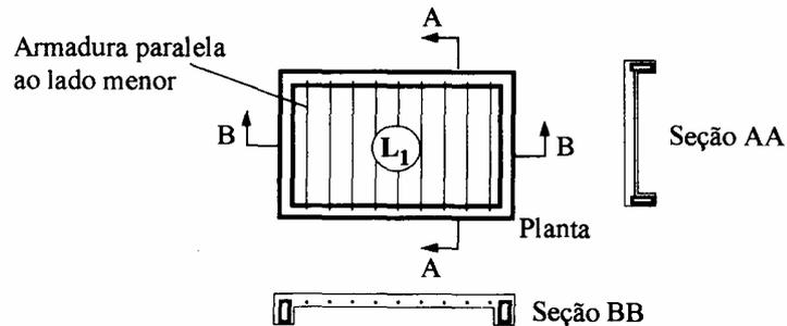
As lajes armadas em uma só direção são calculadas exatamente como se fossem um conjunto de vigas paralelas, sendo que o cálculo da área de aço é feita por metro de laje. Para elas não são aplicáveis as tabelas de Marcus que são usadas para as lajes em cruz.
