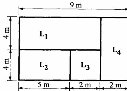
Quando dizemos laje armada em duas direções estamos falando de armação dos momentos positivos que ocorrem nas duas direções no meio do vão. As lajes armadas em uma só direção só possuem armação na direção do vão menor.
