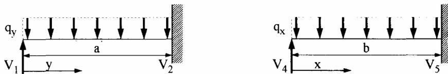
O diagrama de Momentos Fletores será, ressaltando-se que os engastamentos indicados não são nas vigas e sim engastamento laje com laje.
