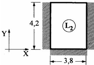
Adotar uma sobrecarga de  $200 \text{ kg/m}^2$  que é igual à  $0,2 \text{ t/m}^2$ . Admitiu-se que a espessura da laje é de 11 cm.
