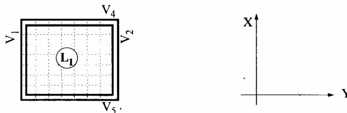
Dentro desse raciocínio, cada laje é substituída, por um reticulado de vigas na direção X e na direção Y. Segundo algum critério deveremos dividir a carga atuante e acidental  $q$  em duas cargas  $q_x$  e  $q_y$  que se distribuirão nas vigas na direção X e na direção Y.
