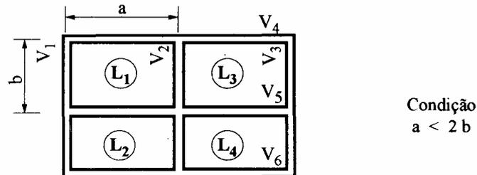
Podemos considerar cada laje como se fosse formada por uma grelha de vigas independentes se cortando perpendicularmente como a seguir se mostra para a laje  $L_1$ .
