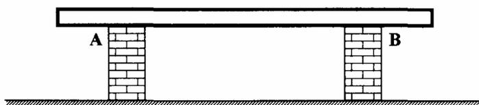
A barra pode subir no ponto A e no ponto B. A barra, todavia, não pode descer em A ou B (a estrutura de apoio não deixa). Essa estrutura é portanto estável, se receber um esforço vertical
