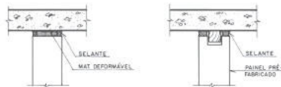
Figura 4. Acabamento de juntas com selante flexível.
