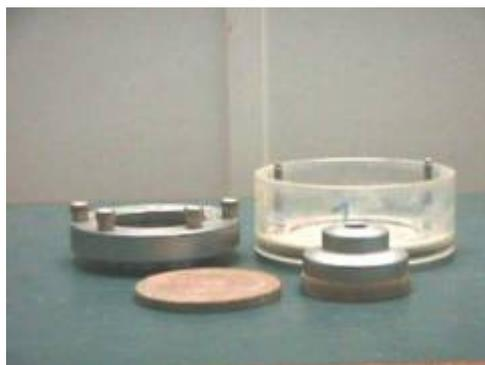
Após a colocação do anel com o provete na câmara do edómetro, procede-se à leitura inicial (leitura zero). Em seguida enche-se a câmara do edómetro com água, de forma a que a amostra e a placa porosa superior fiquem completamente submersas, de modo a evitar eventual evaporação de água, conservando, por isso, o estado de saturação. As superfícies da amostra ficam em contacto com as placas porosas, permitindo assim uma rápida drenagem durante a compressão.
