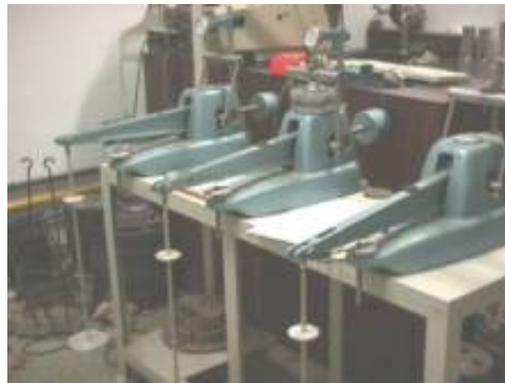
Este ensaio consiste em submeter o provete a pressões crescentes estando o solo confinado lateralmente e sujeito a uma carga axial, com drenagem livre, quer no topo quer na base. Avaliam-se assim a variação dos assentamentos no tempo e o assentamento total.
