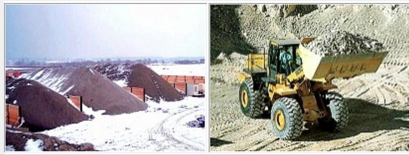
**Nas Centrais Dosadoras os agregados devem ser separados em baias e são colocados nas balanças ou caixas com o auxílio de uma pá carregadeira.**
