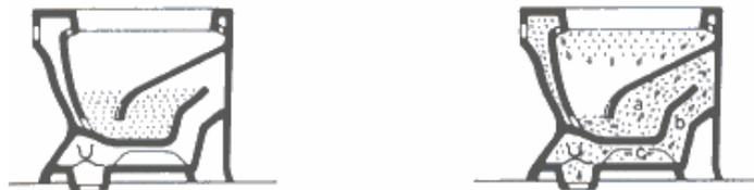
Figura 13. Vaso sanitário auto-sifonado, canal dianteiro.
