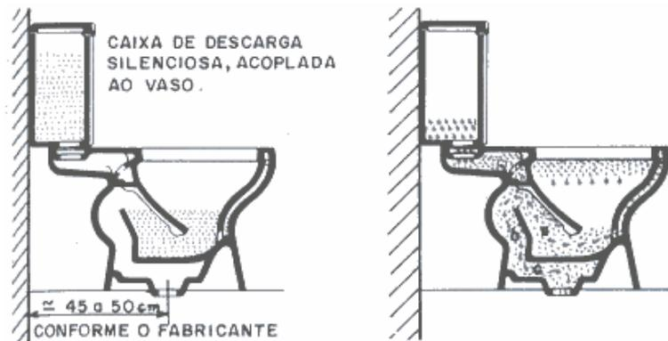
Figura 14. Vaso sanitário auto-sifonado, canal posterior.
